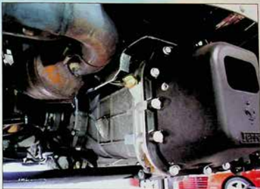
Foto cambio/differenziale in vettura (nel caso i gruppi siano divisi, riportare la fotografia del cambio)
